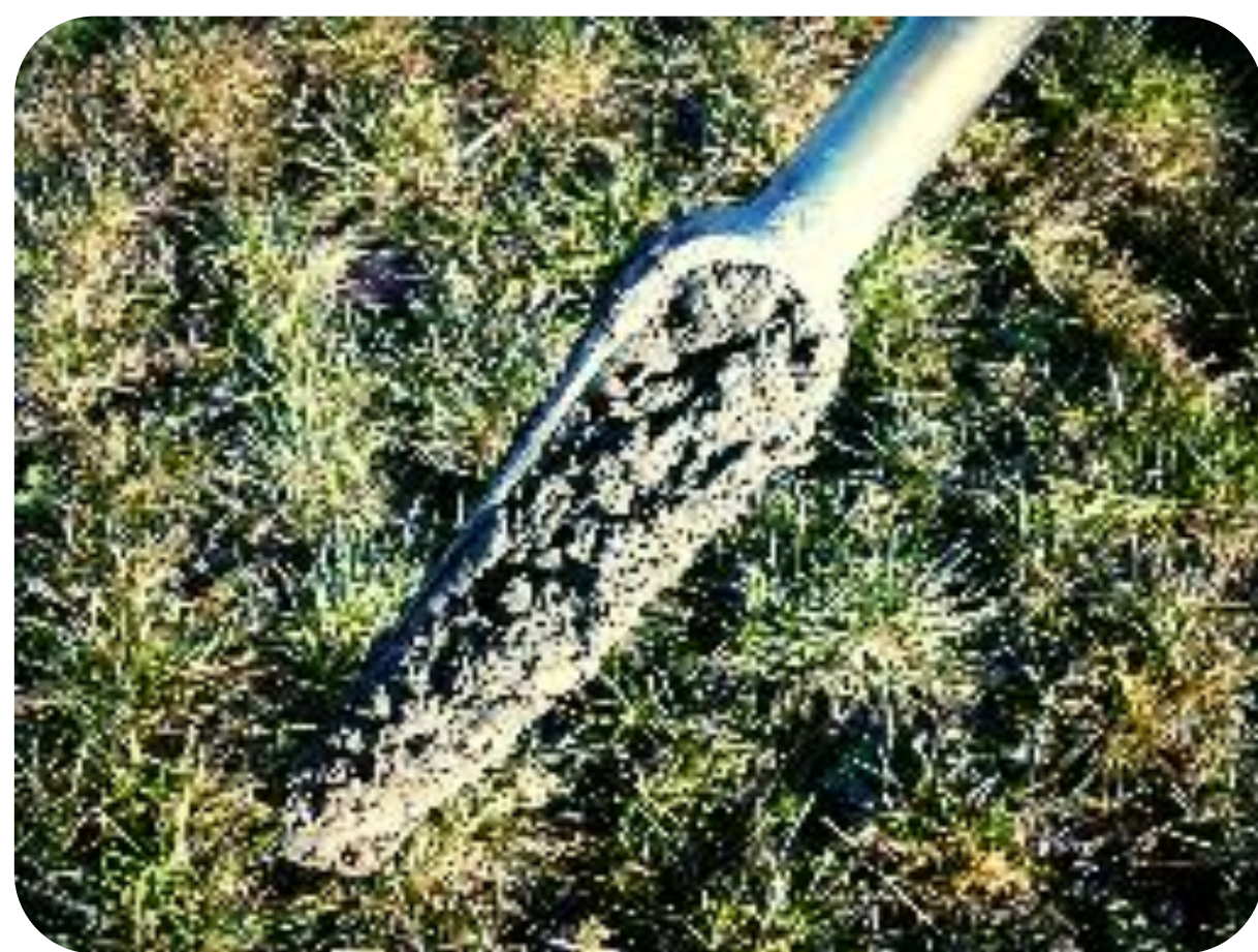
Tarière de prélèvement (tarière hollandaise)
