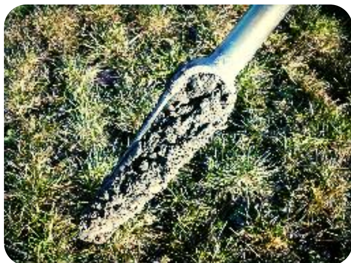
Tarière de prélèvement (tarière hollandaise)
